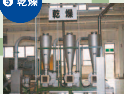
破碎されたチップを乾燥させます。
