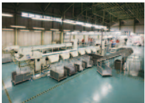
破碎されたチップを乾燥させます。
