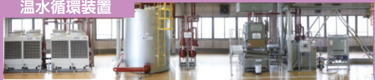
洗浄水を温度保持しながらアルカリ濃度を一定に保つ装置。
