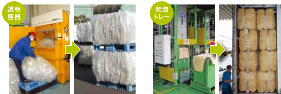
選別済みのトレー・容器は圧縮して大幅に減容します
